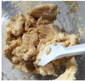
Gambar 4. Pasta campuran minyak jelantah dan KOH
