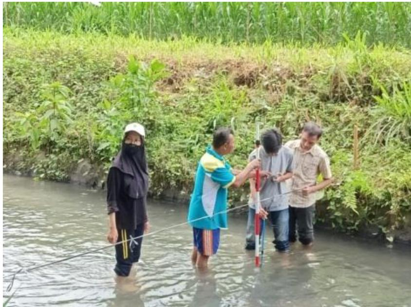
Gambar 4. Kegiatan Pengukuran Kecepatan Aliran dengan Current Meter
