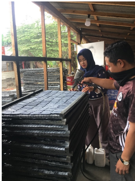
Gambar 2. Proses penyemprotan pemberian anti gores pada produk kayu
